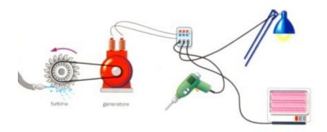
l'energia meccanica dell'acqua si trasforma in energia meccanica della turbina e questa a sua volta, attraverso il generatore, in energia elettrica e, quindi, in energia elettromagnetica
