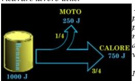
Il motore di un'automobile, ad esempio, è progettato per trasformare l'energia chimica prodotta dal processo di combustione della benzina in energia meccanica della macchina, tuttavia solo il 25% circa CALORE dell'energia chimica immagazzinata nel carburante viene effettivamente sfruttato.
