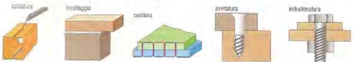
**Saldatura** Unione permanente di due pezzi ottenuta riscaldando i loro lembi, con eventuale materiale di apporto. Si esegue con la saldatrice ad arco e con la saldatrice autogena.
