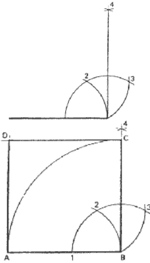
*Tracciare la perpendicolare passante per l'estremità **B** del lato dato **AB**. Fare centro in **B** con raggio uguale ad **AB** e trovare **C**. Con lo stesso raggio, centrare successivamente in **C** e in **A** e tracciare due archi che si intersecano in **D**. Unire i 4 vertici del quadrato.*
