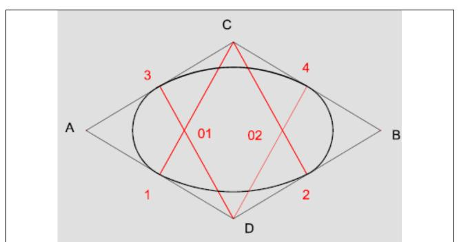
DISEGNARE, NELLO SPAZIO SOTTOSTANTE, LA CIRCONFERENZA IN ASSONOMETRIA ISOMETRICA IN UN QUADRILATERO DI 8 cm DI LATO
