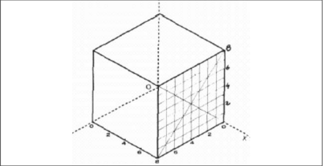
DISEGNARE, NELLO SPAZIO SOTTOSTANTE, UN CUBO DI 6 cm DI LATO IN ASSONOMETRIA ISOMETRICA
